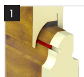
1 Ocieplany panel (grubość 45 mm)
