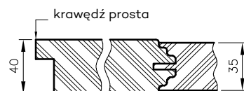
Przekrój poziomy drzwi Nestor
